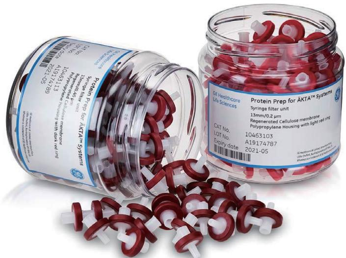
在液相色谱 (LC) 上的最佳应用是在样品上柱子之前预过滤样品。样品的预过滤可以防止无用的颗粒物进入层析柱。这一步非常重要是因为颗粒物会降低层析柱的寿命，延长操作时间，破坏色谱峰的形状。此外，颗粒物也可能会堵塞层析柱进口而引起背压的增高，提早结束层析设备的运行。这些颗粒物相关的问题会导致实验延期，延长设备停机时间，最终会导致实验效率的降低。增加预过滤步骤可以延长层析柱的有效工作时间，降低层析柱更换频率，同时也能保证实验数据的质量。
